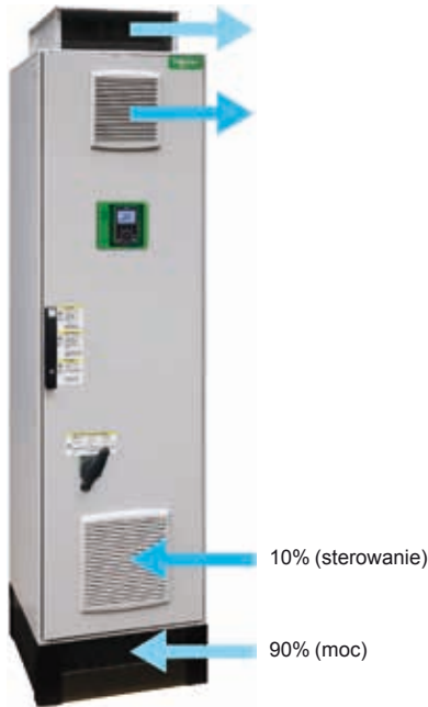
System chłodzenia z dwoma oddzielnymi kanałami powietrza
