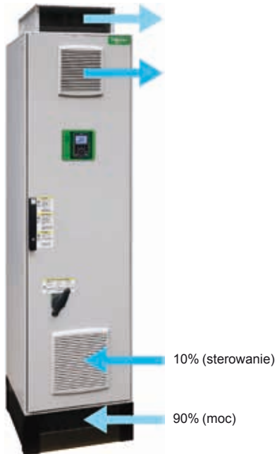
System chłodzenia z dwoma oddzielnymi kanałami powietrza
