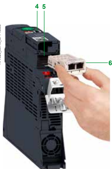
Przykład instalacji modułu komunikacji 6 (widok od spodu) na przeмиenniku w formacie książkowym
