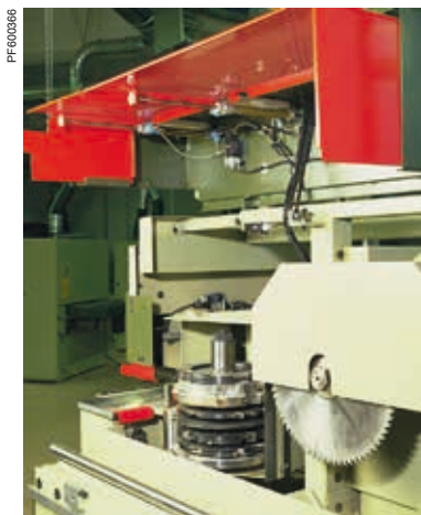
Przykład aplikacji (piła do cięcia) wymagająca obligatoryjnie zastosowania funkcji bezpieczeństwa
