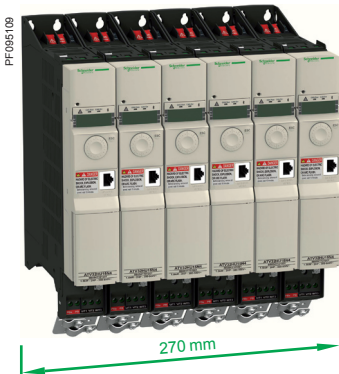
Przykład montażu sześciu ATV32 obok siebie, każdy o wielkości 45mm.
